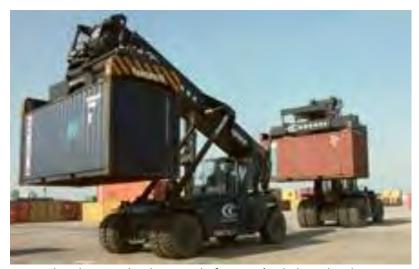
Equipos Reachstaker empleados para la formación de las pilas de contenedores
