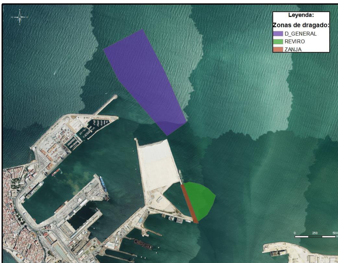
Ilustración 1. Zonas de dragado para cimentación en zanja, relleno y precarga en la Fase II de la terminal de contenedores. Elaboración propia, 2024.
