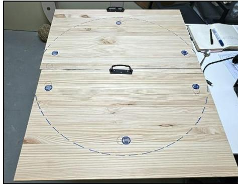
**Ilustración 1. Tablón para el cierre de tuberías de salida al exterior**
