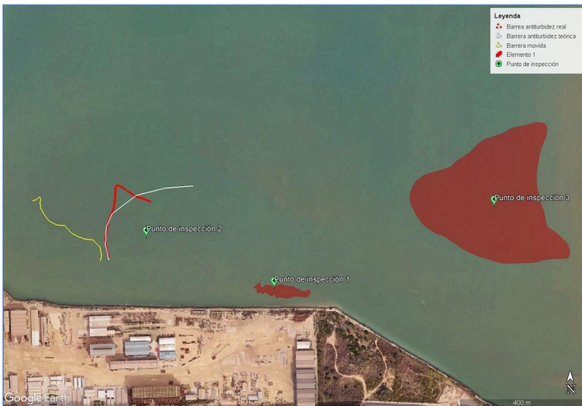
Ilustración 3. Uno de los trazados recogidos en campo por Tecnoambiente del desplazamiento de la barrera
