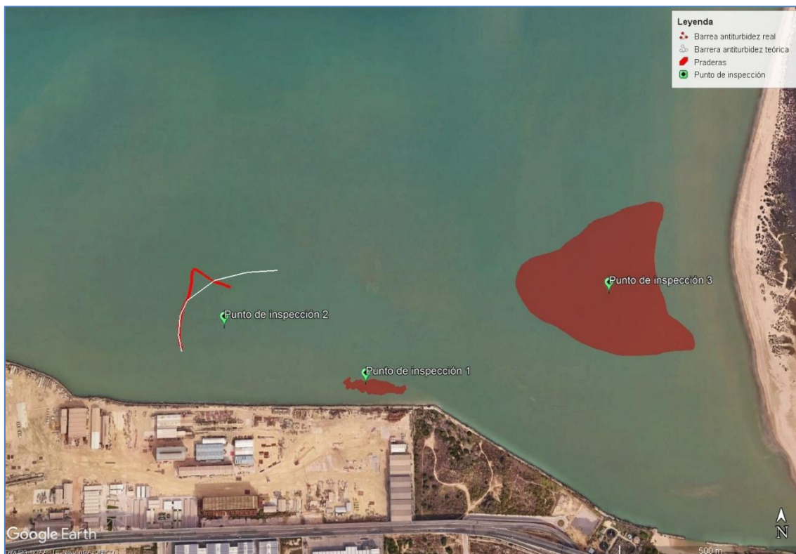
Ilustración 2. Posición teórica y real de la barrera antiturbidez
