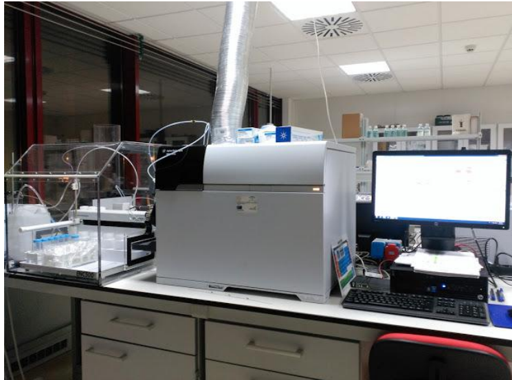
Figura 2.7.- Equipo ICP-MS AGILENT 7900 de la Universidad de Huelva empleado en el análisis de elementos traza y ultratrazo.
