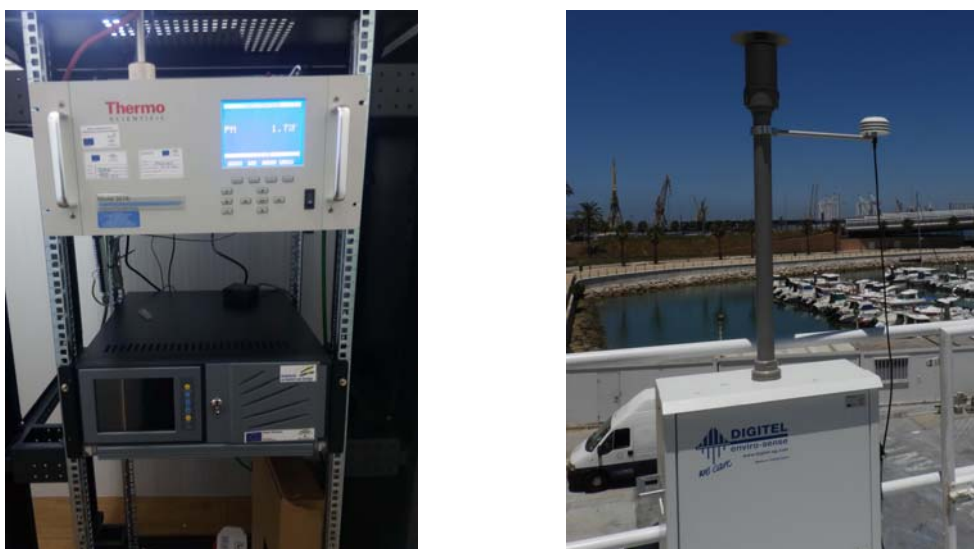
Figura 2.2.- Equipo de Atenuación Beta (Thermo 5014i) para la medida en continuo de PM10 con integrador de datos (izquierda) y captador de bajo volumen DIGITEL DPA14 para el muestreo de partículas PM10.
