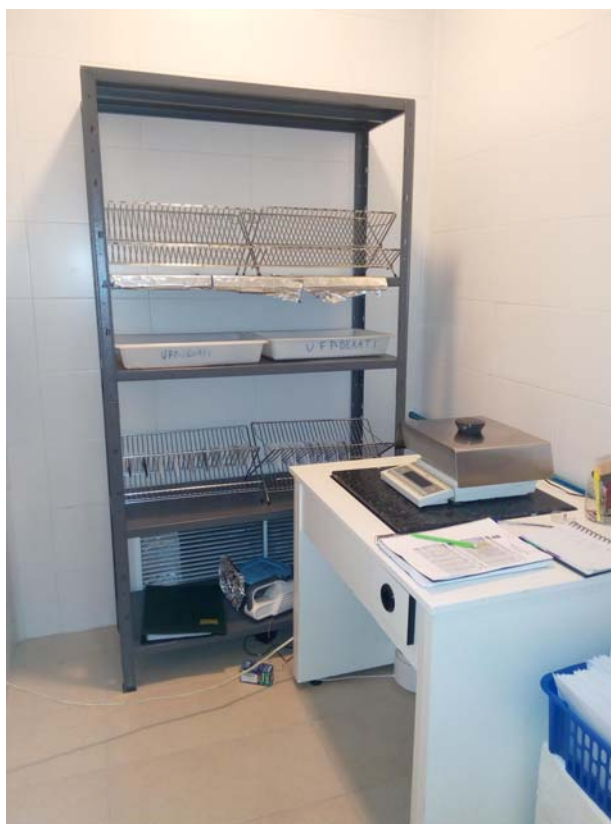
Figura 2.3.- Sala de gravimetría con control automatizado de T y HR, y balanza SARTORIUS de plato ancho para la pesada de filtros blancos y con partículas muestreadas en este estudio.
