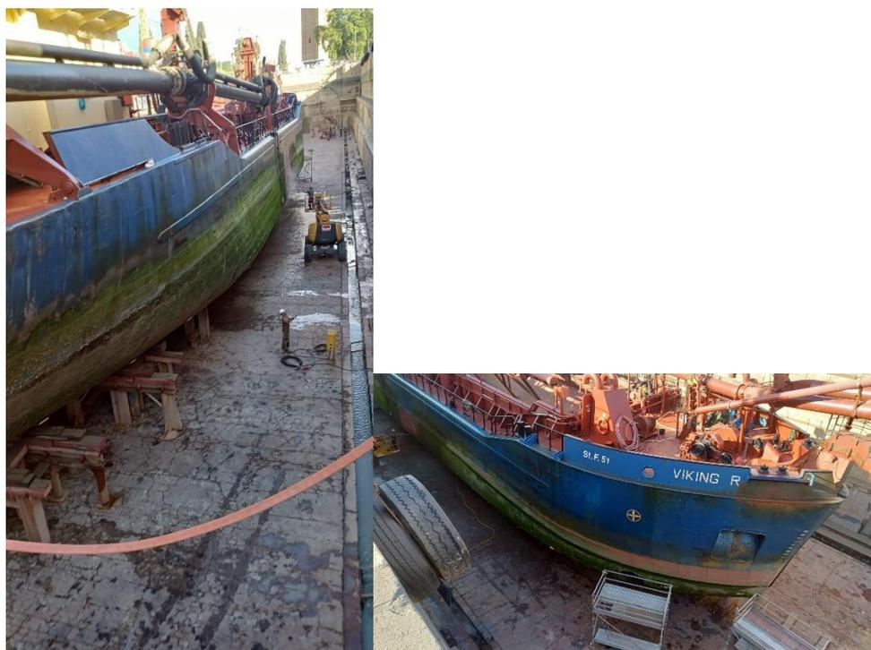
*Ilustración 1. Fotografías de la obra viva de la Viking-R en el dique seco del puerto de Sevilla*
