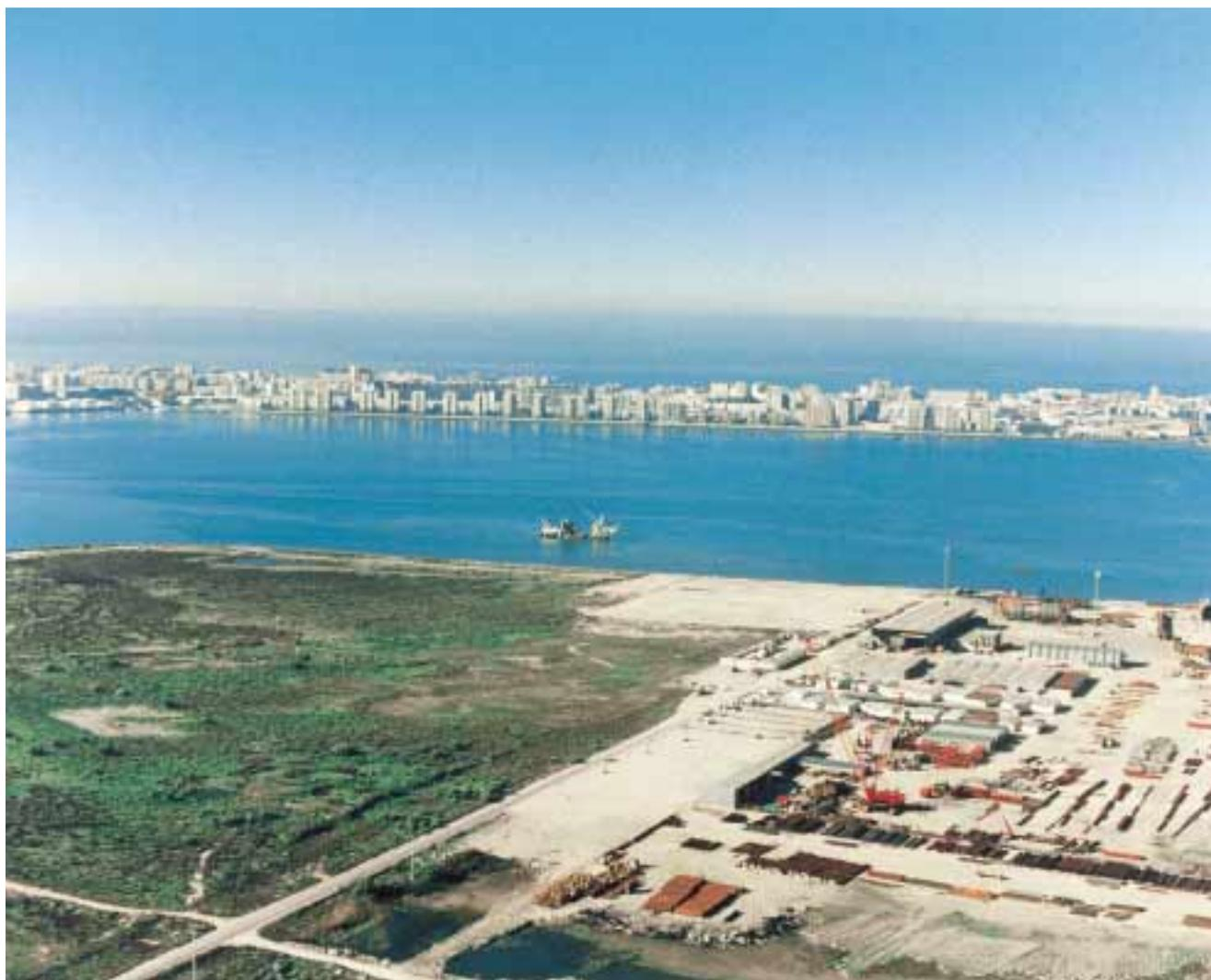
*En el año 1986 se inician los trabajos de la 1ª fase de la construcción del Muelle de La Cabezuela (T.M. de Puerto Real ), donde se trasladarían todas las operaciones de carga y descarga de graneles sólidos llevadas a cabo en el Muelle Marqués de Comillas de la dársena de Cádiz. El nuevo muelle contaría con 493 metros de línea de atraque y 14 metros de calado.*
