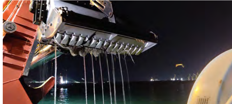
Figura 02 - Seguimiento y control arqueológico del dragado a bordo de la Viking R para la fase II de la ampliación de la NTC. Cabezal con material de desecho proveniente de la bocana del puerto.
