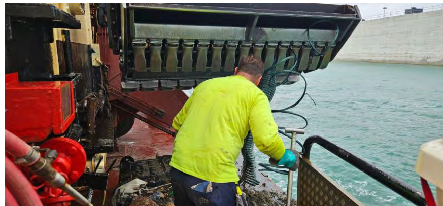
Figura 02- Seguimiento y control arqueológico del dragado para la Fase II de la ampliación de la NTC, a bordo de la Viking R. Revisión de la limpieza de la cabeza de succión al finalizar la 2ª carga del turno. Material de desecho. Resultado negativo.
