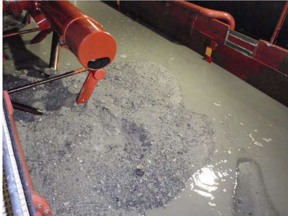
Figura 02- Seguimiento y control arqueológico del dragado para la Fase II de la ampliación de la NTC, a bordo de la Viking R. Supervisión de la cántara tras la 2ª carga del turno, detalle del tipo de sedimento (fangos, limos arenosos y piedras). Resultado negativo.
