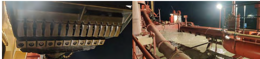
Figura 01 - Seguimiento y control arqueológico del dragado a bordo de la Viking R para la fase II de la ampliación de la NTC. Revisión del cabezal y la cántara en la primera carga.
