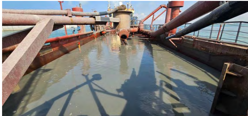
Figura 03 - Seguimiento y control arqueológico del dragado para la Fase II de la ampliación de la NTC, a bordo de la Viking R. Supervisión de la cántara tras la 2ª carga del turno. La cantidad de agua a bordo, imposibilita la revisión y/o recuperación del posible material arqueológico.
