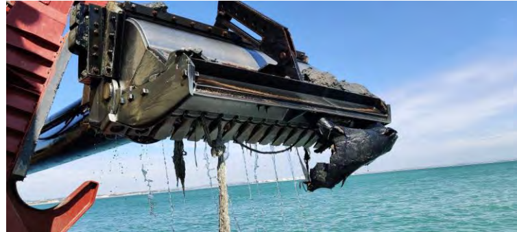
Figura 02 - Seguimiento y control arqueológico del dragado a bordo de la Viking R para la fase II de la ampliación de la NTC. Detalle del cabezal con material de desecho proveniente de la bocana.
