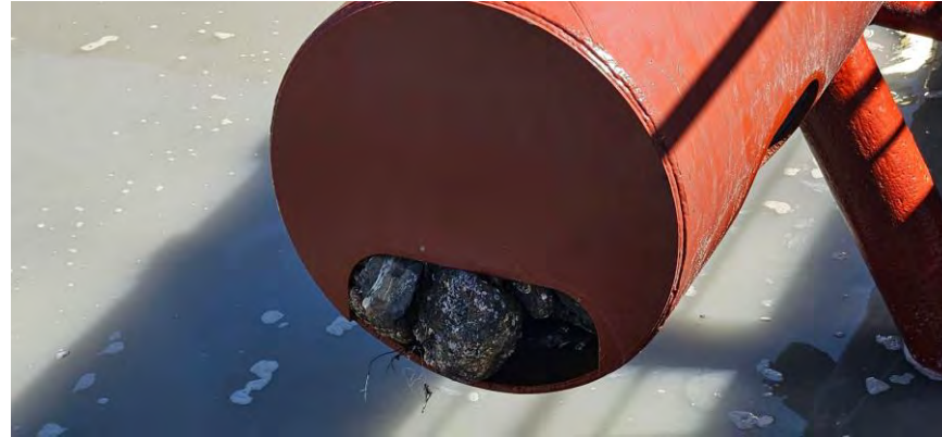
Figura 03 - Seguimiento y control arqueológico de la Fase II de la ampliación de la NTC, a bordo de la Viking R. Supervisión de las labores de dragado, trazado, tipo de sedimento,.. Detalle material. Tubería atascada por las piedras existentes.
