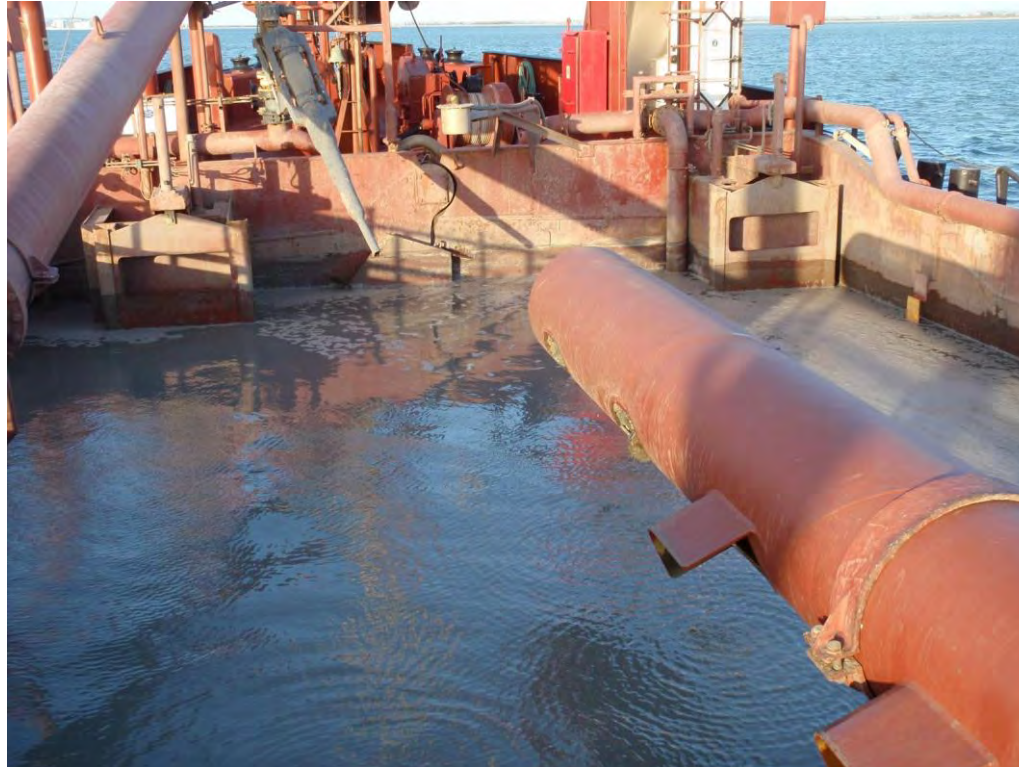
Figura 10 - Seguimiento y control arqueológico del dragado para la Fase II de la ampliación de la NTC, a bordo de la Viking R. Supervisión de la cántara tras la 3ª carga del turno, detalle del tipo de sedimento (fangos, limos arenosos y piedras). Resultado negativo.
