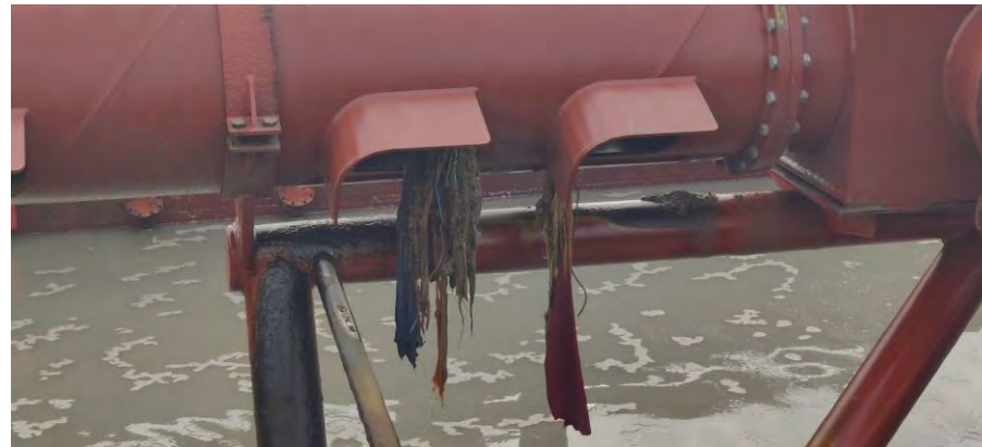
Figura 02 - Seguimiento y control arqueológico del dragado a bordo de la Viking R para la fase II de la ampliación de la NTC. Detalle de restos de redes en los difusores.
