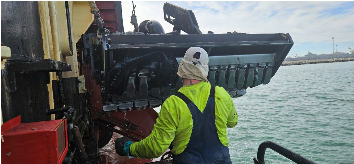
Figura 9. Labores de limpieza, cabezal de la draga.
