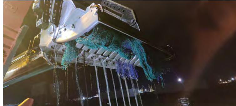
Figura 02 - Seguimiento y control arqueológico del dragado a bordo de la Viking R para la fase II de la ampliación de la NTC. Detalles del cabezal lleno de redes de pesca.
