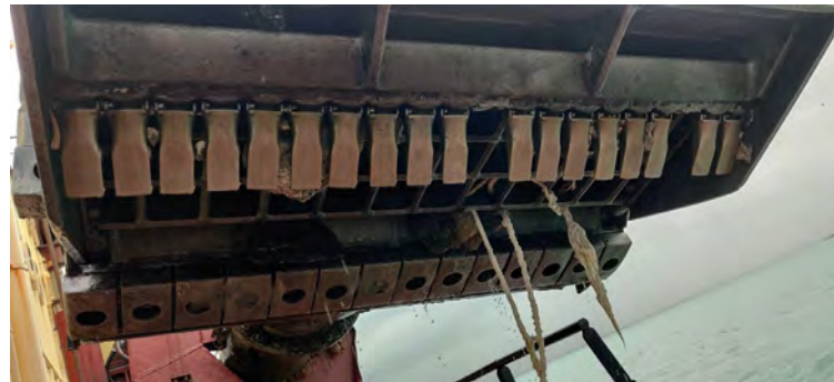
Figura 01 - Seguimiento y control arqueológico del dragado a bordo de la Viking R para la fase II de la ampliación de la NTC. Revisión del cabezal en la primera carga.
