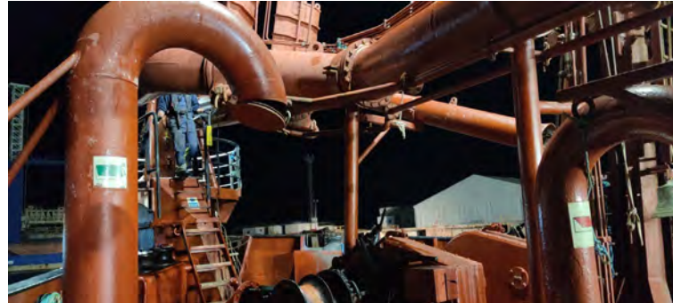
Figura 04 - Seguimiento y control arqueológico del dragado a bordo de la Viking R para la fase II de la ampliación de la NTC. Detalle de maniobra de unión del tubo para relleno de la nueva terminal de contenedores Fase II.
