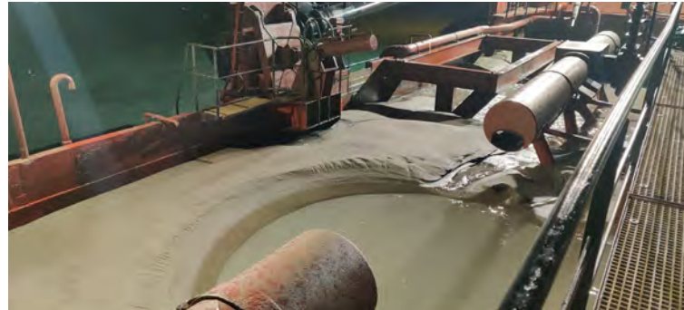
Figura 01 - Seguimiento y control arqueológico del dragado a bordo de la Viking R para la fase II de la ampliación de la NTC. Playa formada en la cántara tras la carga en la bocana del puerto (material de arena fina).
