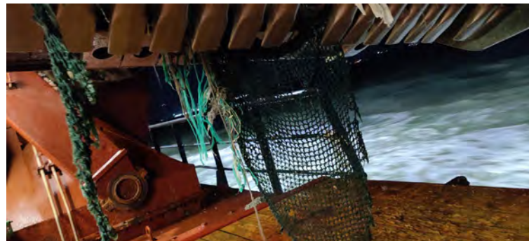
Figura 02 - Seguimiento y control arqueológico del dragado a bordo de la IDUN R para la fase II de la ampliación de la NTC. Revisión del cabezal de succión lleno de material de desecho.
