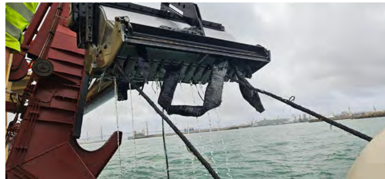
Figura 02- Seguimiento y control arqueológico del dragado para la Fase II de la ampliación de la NTC, a bordo de la Viking R. Revisión de la limpieza de la cabeza de succión al finalizar la 1ª carga del turno. Material de desecho. Resultado negativo.
