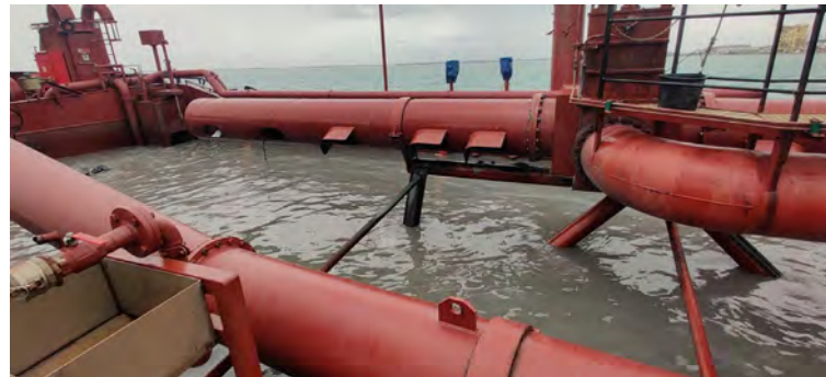
Figura 05 - Seguimiento y control arqueológico del dragado a bordo de la Viking R para la fase II de la ampliación de la NTC. Cántara inundada en todas las cargas imposibilitando la inspección visual.
