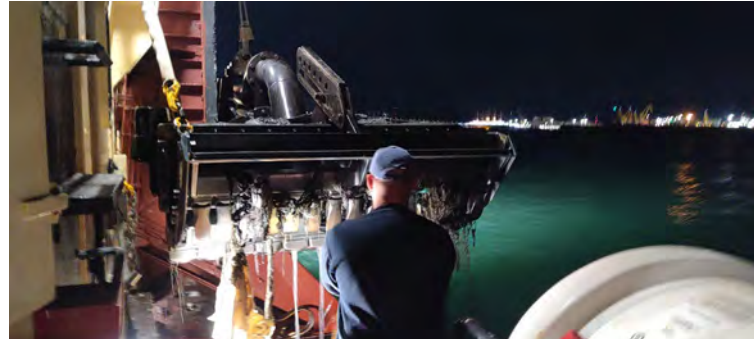
Figura 02 - Seguimiento y control arqueológico del dragado a bordo de la Viking R para la fase II de la ampliación de la NTC. Revisión del cabezal lleno de material de desecho.
