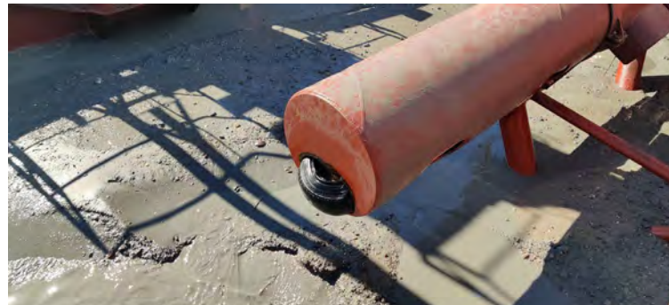
Figura 03 - Seguimiento y control arqueológico del dragado a bordo de la Viking R para la fase II de la ampliación de la NTC. Detalle del material de desecho atascando el difusor que conecta con la cántara.
