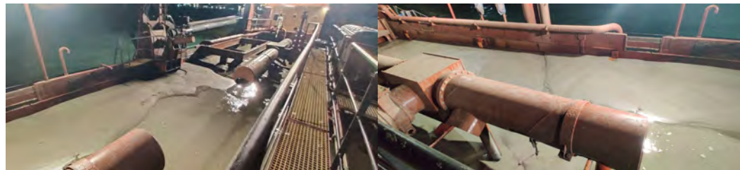
Figura 03 - Seguimiento y control arqueológico del dragado a bordo de la Viking R para la fase II de la ampliación de la NTC. "Playa" Formada en la cántara tras la carga.
