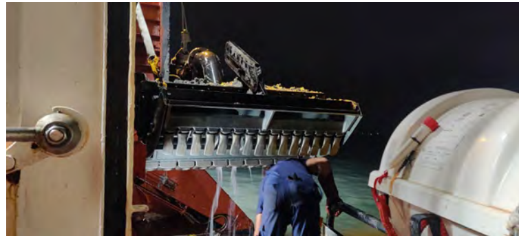
Figura 03 - Seguimiento y control arqueológico del dragado a bordo de la Viking R para la fase II de la ampliación de la NTC. Detalle del cabezal siendo limpiado de sedimentos por el mariner de la Viking.
