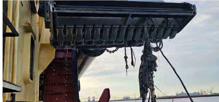
Figura 01 - Seguimiento y control arqueológico del dragado para la Fase II de la ampliación de la NTC, a bordo de la Viking R. Revisión de la limpieza de la cabeza de succión tras la 1ª carga completada en el turno. Material de desecho. Resultado negativo.
