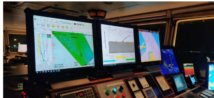
Figura 01 - Seguimiento y control arqueológico del dragado a bordo de la Viking R para la fase II de la ampliación de la NTC. Detalle de la zona de trabajo con MDT, profundidad del cabezal y mapa de la zona.
