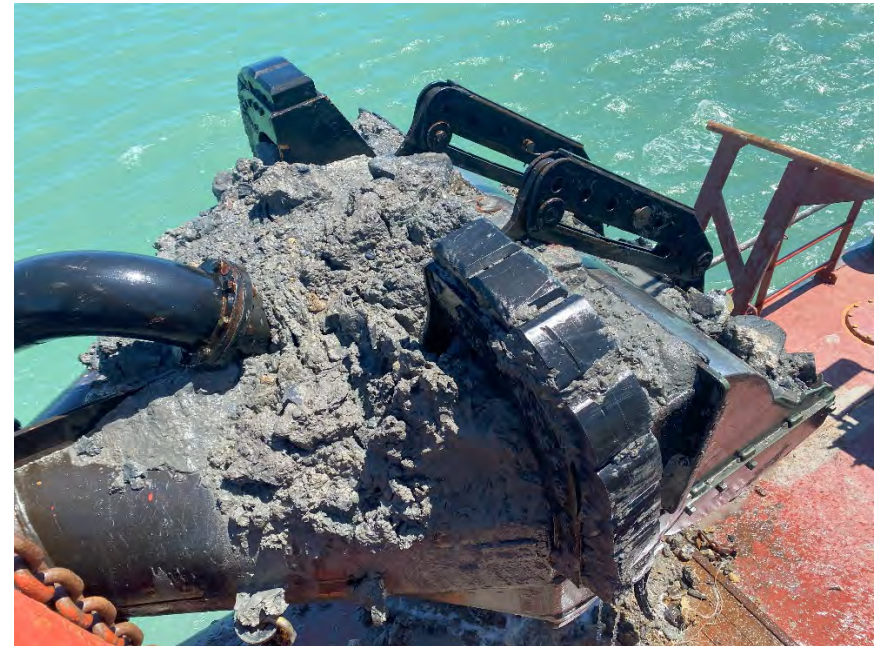
Figura 02 - Seguimiento y control arqueológico del dragado a bordo de la SIF R- Inspección de la cabeza de la draga una vez finaliza la carga. Se puede apreciar la consistencia arcillosa de los estratos entre -12/-14 metros.
