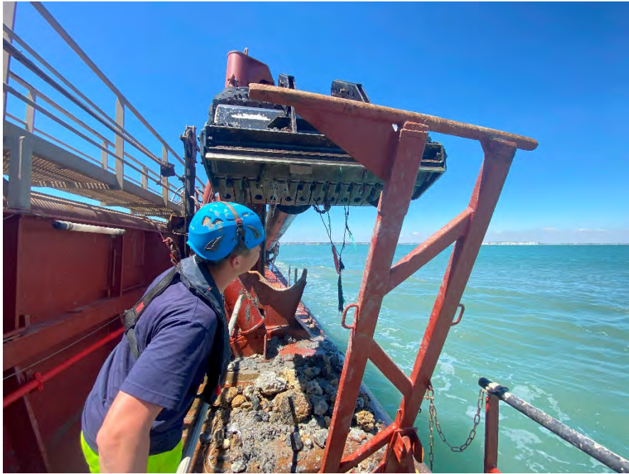
Figura 02 - Seguimiento y control arqueológico del dragado a bordo de la SIF R- Inspección de la cabeza de la draga una vez finaliza la carga. Remoción del material incrustado en el interior de la cabeza de succión
