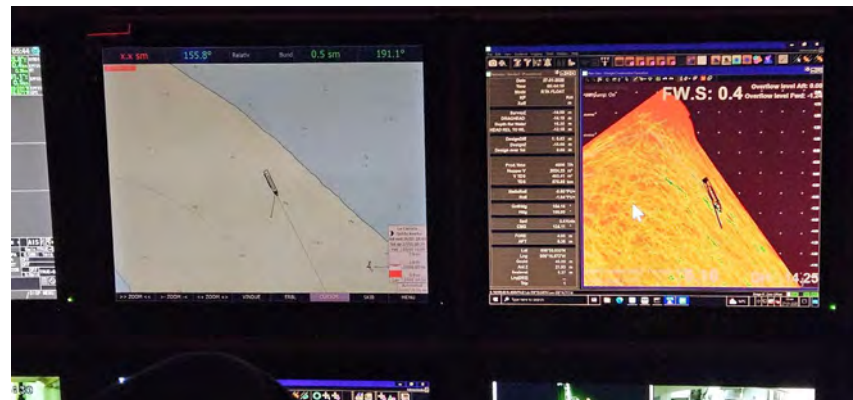
Figura 08 - Seguimiento y control arqueológico de la Fase II de la ampliación de la NTC, a bordo de la Brage R Supervisión de las labores de dragado, trazado, tipo de sedimento,.. Monitor del multihaz con la zona de dragado, las profundidades y la posición de la draga en la bocana del puerto durante la 3ª carga completada en el turno.
