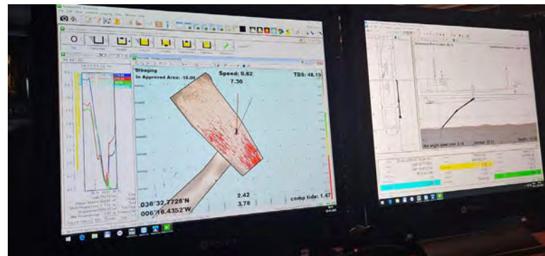
Figura 12 - Seguimiento y control arqueológico de la Fase II de la ampliación de la NTC, a bordo de la Viking R Supervisión de las labores de dragado, trazado, tipo de sedimento,.. Monitor del multihaz con la zona de dragado, las profundidades y la posición de la draga en la zona de la bocana del puerto de Cádiz durante la 4ª carga realizada en el turno.
