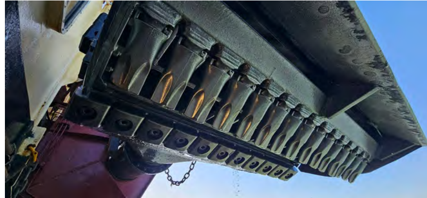
Figura 05 - Seguimiento y control arqueológico del dragado para la Fase II de la ampliación de la NTC, a bordo de la Viking R. Revisión de la cabeza de succión tras la 2ª carga realizada en el turno. Resultado negativo.
