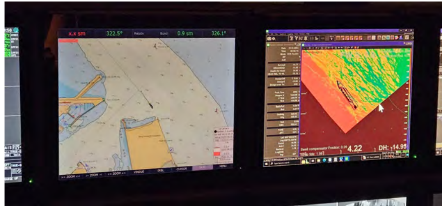
Figura 05 - Seguimiento y control arqueológico de la Fase II de la ampliación de la NTC, a bordo de la Brage R. Supervisión de las labores de dragado, trazado, tipo de sedimento,.. Monitor del multihaz con la zona de dragado, las profundidades y la posición de la draga en la bocana del puerto durante la 2ª carga realizada en el turno.
