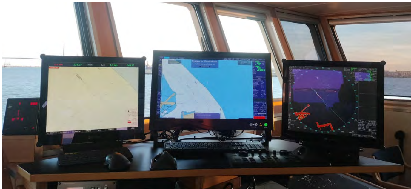
Figura 05 – Seguimiento y control arqueológico de la Fase II de la ampliación de la NTC a bordo de la Brage R. Monitores con la posición de la draga durante la 3ª descarga del turno de día.
