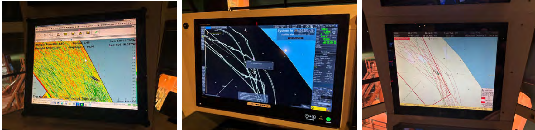
Figura 04, 05 y 06- Seguimiento y control arqueológico del dragado para la Fase II de la ampliación de la NTC, a bordo de la IDUNR. Monitor del multihaz con la zona de dragado, las profundidades y la posición de la draga en la zona de la bocana. Resultado negativo.
