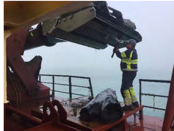
Figura 01 - Seguimiento y control arqueológico del dragado para la Fase II de la ampliación de la NTC, a bordo de la Idun R. Imágenes de la monitorización del área de dragado y de la revisión del cabezal de succión en la primera carga. Resultado negativo.
