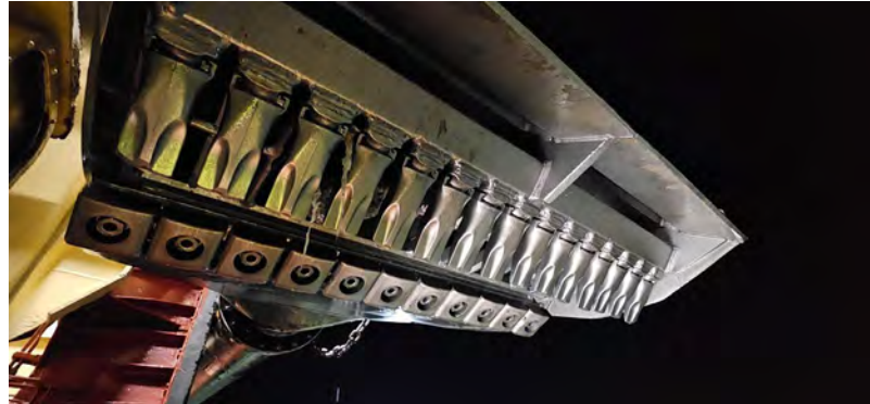
Figura 17 - Seguimiento y control arqueológico del dragado para la Fase II de la ampliación de la NTC, a bordo de la Viking R. Revisión de la cabeza de succión tras la 5ª carga completada en el turno. Resultado negativo.
