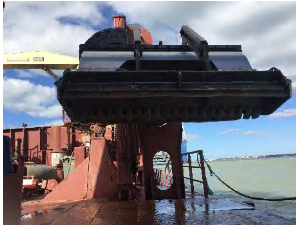
Figura 01 - Seguimiento y control arqueológico del dragado para la Fase II de la ampliación de la NTC, a bordo de la Brage R. Imágenes del cabezal de succión y del sedimento extraído en la tolva tras la primera carga. Resultado negativo.
