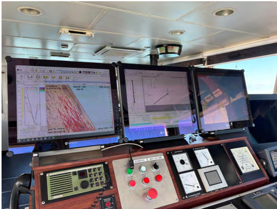
Figura 01 y 02 - Seguimiento y control arqueológico de la Fase II de la ampliación de la NTC, a bordo de la Viking R. Monitor del multihaz con la zona de dragado, las profundidades y la posición de la draga en la zona de la bocana del puerto de Cádiz durante la 1ª carga completada en el turno.
