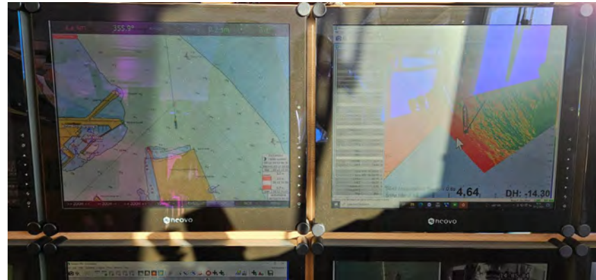
Figura 09 - Seguimiento y control arqueológico de la Fase II de la ampliación de la NTC, a bordo de la Brage R Supervisión de las labores de dragado, trazado, tipo de sedimento,.. Monitor del multihaz con la zona de dragado, las profundidades y la posición de la draga en la bocana del puerto durante la 3ª carga completada en el turno.
