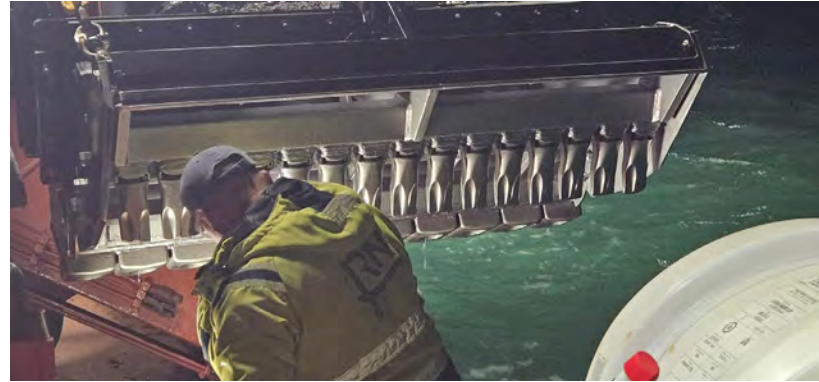
Figura 13 - Seguimiento y control arqueológico del dragado para la Fase II de la ampliación de la NTC, a bordo de la Viking R. Revisión de la cabeza de succión tras la 4ª carga completada en el turno. Resultado negativo.
