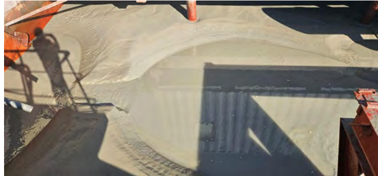
Figura 07 - Seguimiento y control arqueológico del dragado para la Fase II de la ampliación de la NTC, a bordo de la Viking R. Supervisión de la cántara tras la 2ª carga completada. La cantidad de agua mantenida a bordo imposibilita la revisión del material extraído. Resultado negativo.
