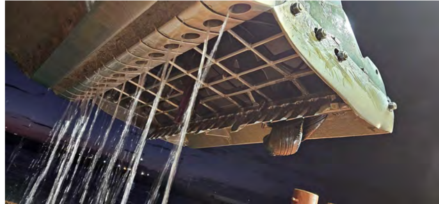
Figura 11 - Seguimiento y control arqueológico del dragado para la Fase II de la ampliación de la NTC, a bordo de la Brage R. Revisión de la limpieza de la cabeza de succión tras la 3ª carga completada en el turno. Material de desecho. Resultado negativo.
