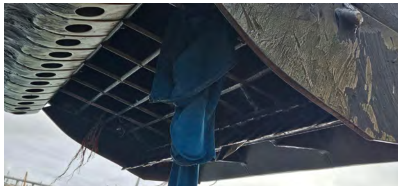
Figura 07 - Seguimiento y control arqueológico del dragado para la Fase II de la ampliación de la NTC, a bordo de la Brage R. Revisión de la limpieza de la cabeza de succión tras la 2ª carga completada en el turno. Material de desecho. Resultado negativo.
