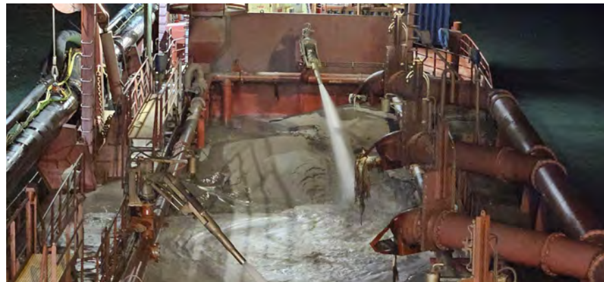
Figura 12 - Seguimiento y control arqueológico de la Fase II de la ampliación de la NTC, a bordo de la Brage R. Supervisión de la 3ª descarga realizada en el turno a través de tubería para el relleno de la dársena.
