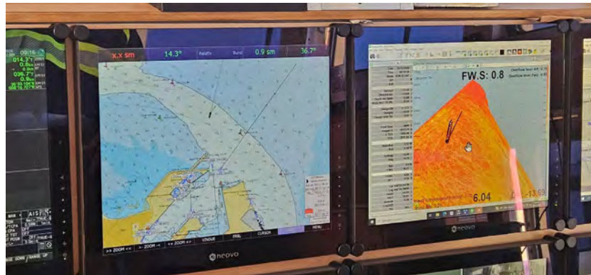
Figura 01 - Seguimiento y control arqueológico de la Fase II de la ampliación de la NTC, a bordo de la Brage R. Supervisión de las labores de dragado, trazado, tipo de sedimento,.. Monitor del multihaz con la zona de dragado, las profundidades y la posición de la draga en la bocana del puerto durante la 1ª carga completada en el turno.
