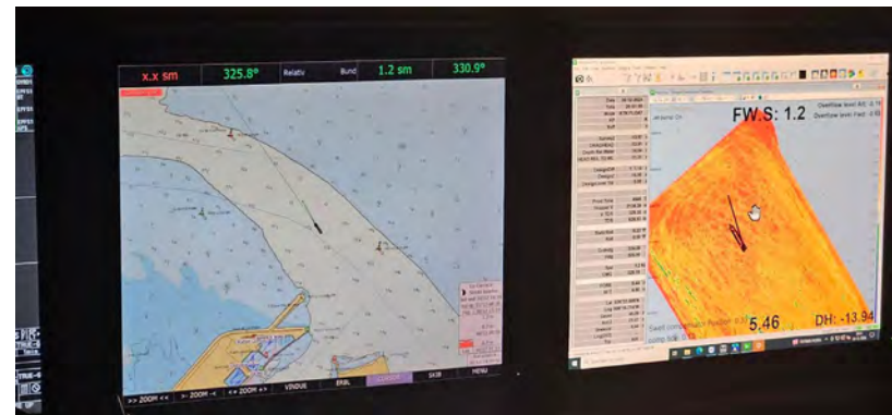
Figura 01 - Seguimiento y control arqueológico de la Fase II de la ampliación de la NTC, a bordo de la Brage R. Supervisión de las labores de dragado, trazado, tipo de sedimento,.. Monitor del multihaz con la zona de dragado, las profundidades y la posición de la draga en la boca del puerto durante la 1ª carga realizada en el turno.
