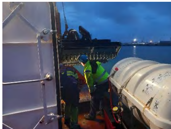
Figura 04 - Seguimiento y control arqueológico del dragado para la Fase II de la ampliación de la NTC, a bordo de la Viking R. Imágenes de la revisión del cabezal de succión y del sedimento extraído tras la cuarta carga. Resultado negativo.
