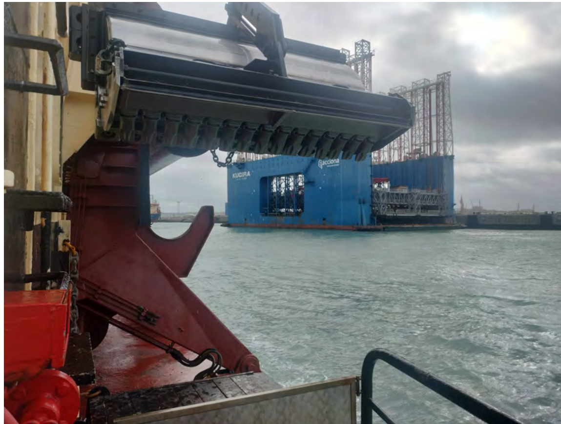
Figura 03 – Seguimiento y control arqueológico de la Fase II de la ampliación de la NTC a bordo de la Viking R. Revisión de la limpieza de la cabeza de succión tras una de las cargas del turno de día. Resultado negativo.
