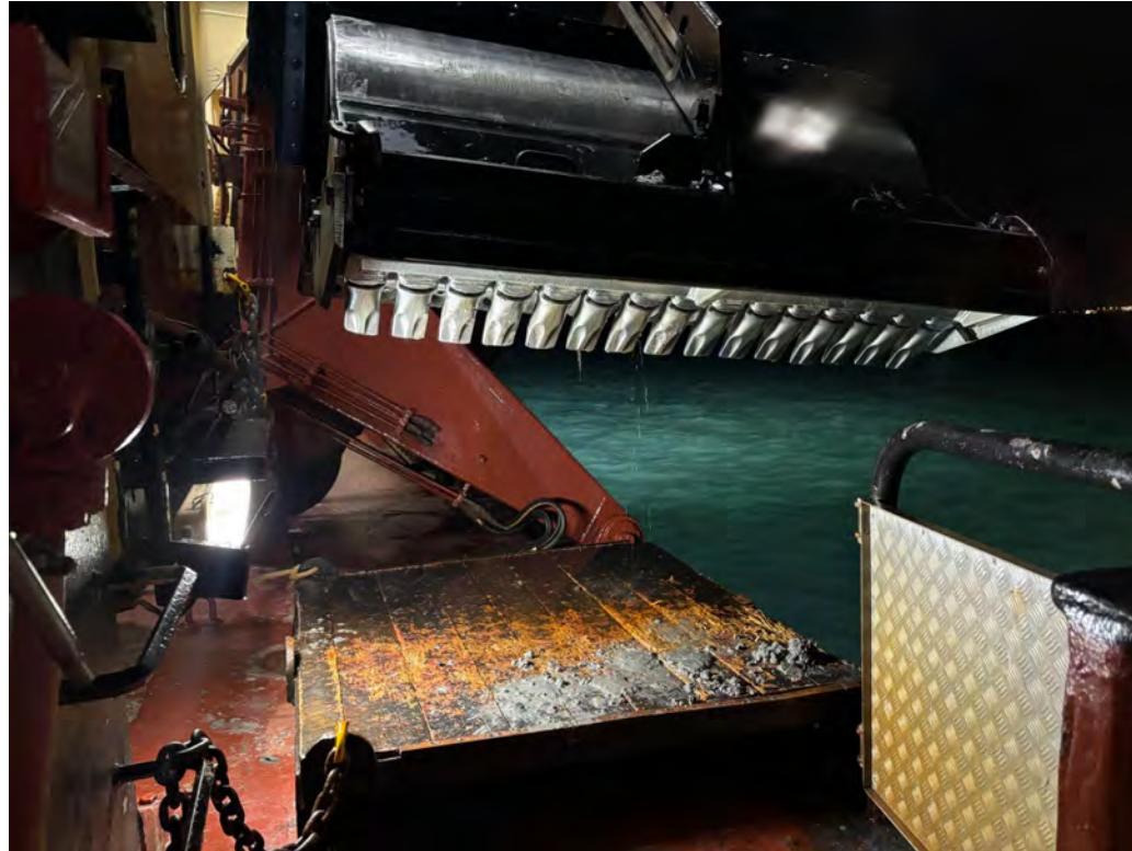
Figura 04 - Seguimiento y control arqueológico del dragado para la Fase II de la ampliación de la NTC, a bordo de la Viking R. Supervisión de la cántara y la cabeza de succión. Resultado negativo.
