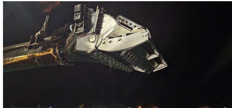
Figura 06 - Seguimiento y control arqueológico del dragado para la Fase II de la ampliación de la NTC, a bordo de la Viking R. Revisión de la cabeza de succión tras la 2ª carga realizada en el turno. Resultado negativo.
