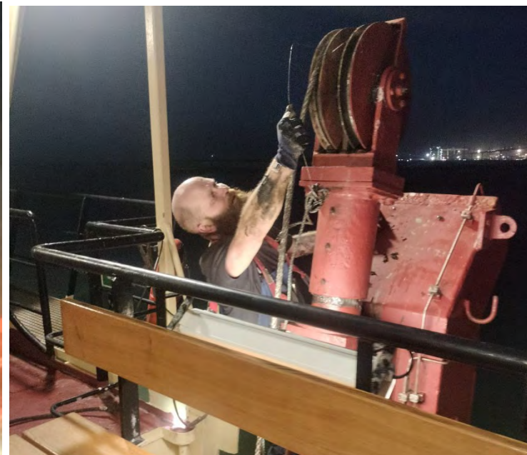
Figuras 4 y 5 – Seguimiento y control arqueológico de la Fase II de la ampliación de la NTC a bordo del Viking R. Reparación del cable de sujeción del cabezal de succión durante el dragado en el interior del puerto de Cádiz.
