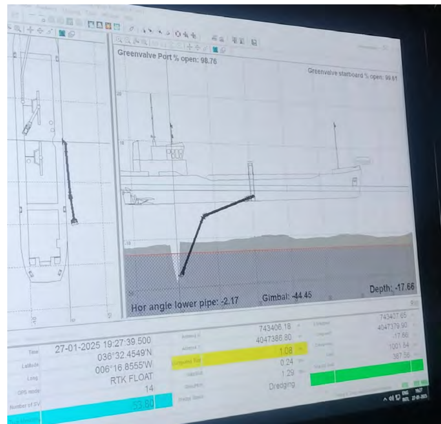
Figuras 5 y 6 – Seguimiento y control arqueológico de la Fase II de la ampliación de la NTC a bordo del Viking R. Posición de la draga en el momento de la avería y situación del cabezal de succión.
