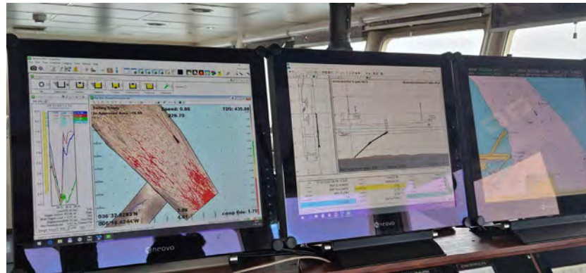
Figura 01 - Seguimiento y control arqueológico de la Fase II de la ampliación de la NTC, a bordo de la Viking R. Supervisión de las labores de dragado, trazado, tipo de sedimento,.. Monitor del multihaz con la zona de dragado, las profundidades y la posición de la draga en la zona de la bocana del puerto de Cádiz durante la 1ª carga realizada en el turno.
