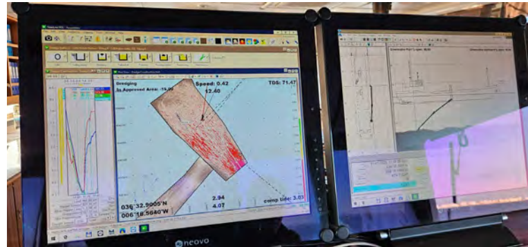
Figura 13 - Seguimiento y control arqueológico de la Fase II de la ampliación de la NTC, a bordo de la Viking R. Supervisión de las labores de dragado, trazado, tipo de sedimento,.. Monitor del multihaz con la zona de dragado, las profundidades y la posición de la draga en la zona de la bocana del puerto de Cádiz durante la 4ª carga realizada en el turno.
