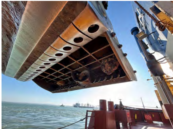
Figura 01, 02 y 03 - Seguimiento y control arqueológico del dragado para la Fase II de la ampliación de la NTC, a bordo de la Brage R. Revisión de la cabeza de succión y la cántara tras la 1ª carga del turno, completada. Resultado negativo.
