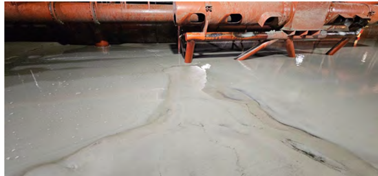
Figura 09 - Seguimiento y control arqueológico del dragado para la Fase II de la ampliación de la NTC, a bordo de la Viking R. Supervisión de la cántara tras la 2ª carga completada. La cantidad de agua mantenida a bordo imposibilita la revisión del material extraído. Resultado negativo.
