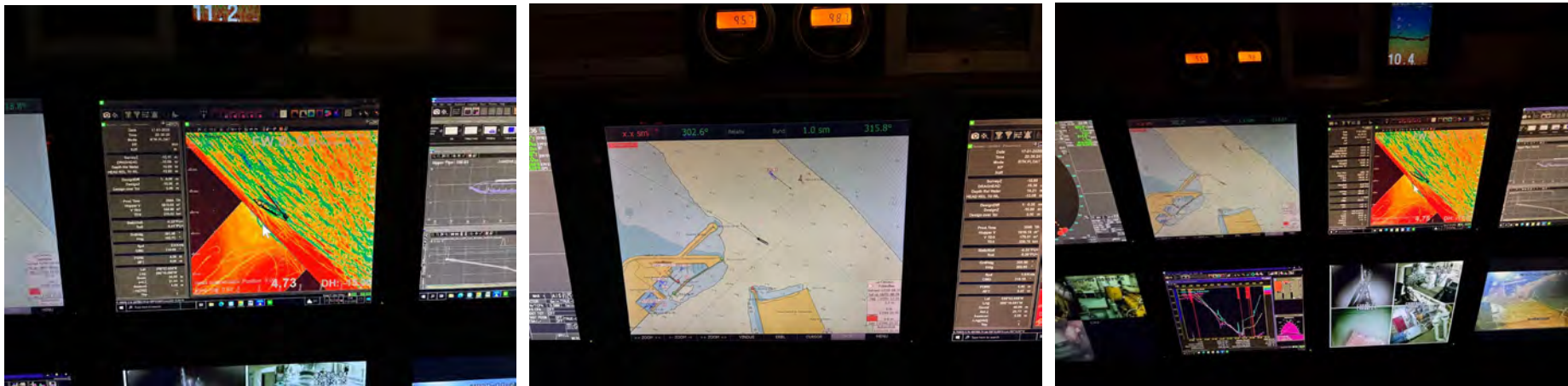
Figura 01, 02 y 03 - Seguimiento y control arqueológico del dragado para la Fase II de la ampliación de la NTC, a bordo de la Brage R. Monitor del multihaz con la zona de dragado, las profundidades y la posición de la draga en la zona de Puerto América. Resultado negativo.
