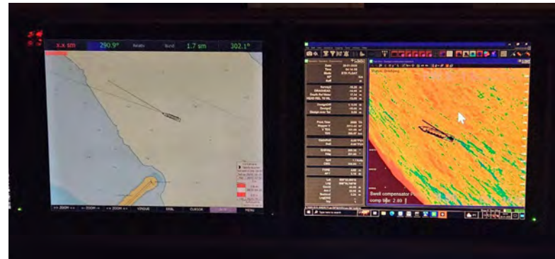
Figura 04 - Seguimiento y control arqueológico de la Fase II de la ampliación de la NTC, a bordo de la Brage R. Supervisión de las labores de dragado, trazado, tipo de sedimento,.. Monitor del multihaz con la zona de dragado, las profundidades y la posición de la draga en la bocana del puerto durante la 2ª carga completada en el turno.
