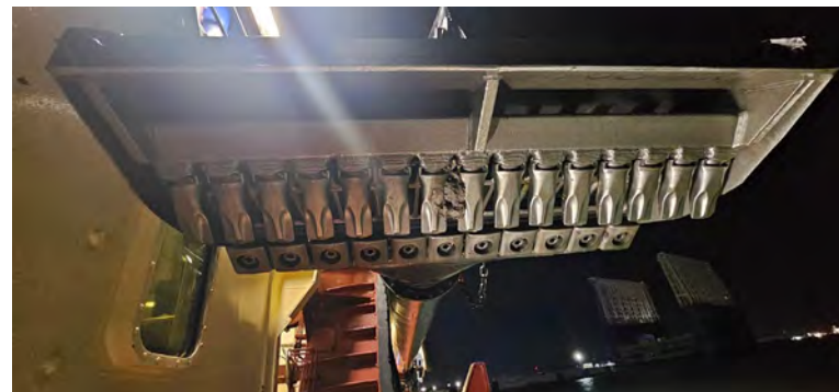
Figura 08 - Seguimiento y control arqueológico del dragado para la Fase II de la ampliación de la NTC, a bordo de la Viking R. Revisión de la cabeza de succión tras la 2ª carga completada en el turno. Resultado negativo.
