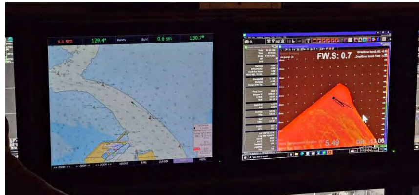
Figura 8 - Seguimiento y control arqueológico de la Fase II de la ampliación de la NTC, a bordo de la Brage R Supervisión de las labores de dragado, trazado, tipo de sedimento,.. Monitor del multihaz con la zona de dragado, las profundidades y la posición de la draga en la bocana del puerto durante la 3ª carga realizada en el turno.
