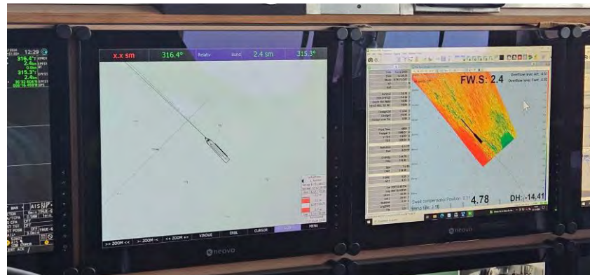
Figura 06 - Seguimiento y control arqueológico de la Fase II de la ampliación de la NTC, a bordo de la Brage R Supervisión de las labores de dragado, trazado, tipo de sedimento,.. Monitor del multihaz con la zona de dragado, las profundidades y la posición de la draga en la bocana del puerto durante la 2ª carga realizada en el turno.
