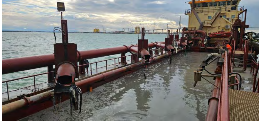
Figura 03 - Seguimiento y control arqueológico del dragado para la Fase II de la ampliación de la NTC, a bordo de la Brage R. Supervisión de la cántara tras la 1ª carga completada. La cantidad de agua mantenida a bordo no permite la revisión del material extraído. Resultado negativo.
