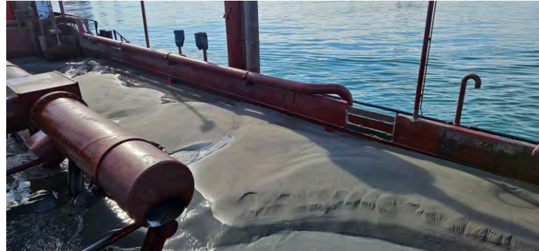
Figura 07 - Seguimiento y control arqueológico del dragado para la Fase II de la ampliación de la NTC, a bordo de la Viking R. Supervisión de la cántara tras la 2ª carga completada. Resultado negativo.
