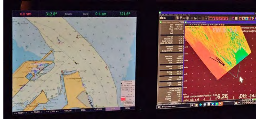
Figura 05 - Seguimiento y control arqueológico de la Fase II de la ampliación de la NTC, a bordo de la Brage R. Supervisión de las labores de dragado, trazado, tipo de sedimento,.. Monitor del multihaz con la zona de dragado, las profundidades y la posición de la draga en la bocana del puerto durante la 2ª carga completada en el turno.
