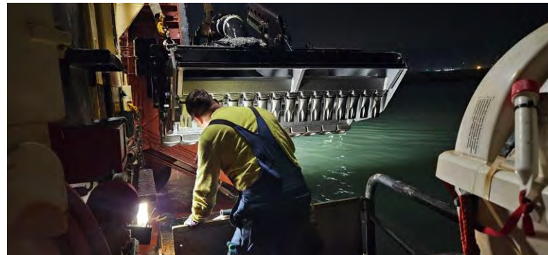
Figura 01 - Seguimiento y control arqueológico del dragado para la Fase II de la ampliación de la NTC, a bordo de la Viking R. Revisión de la limpieza de la cabeza de succión tras la primera carga completada en el turno. Material de desecho. Resultado negativo.
