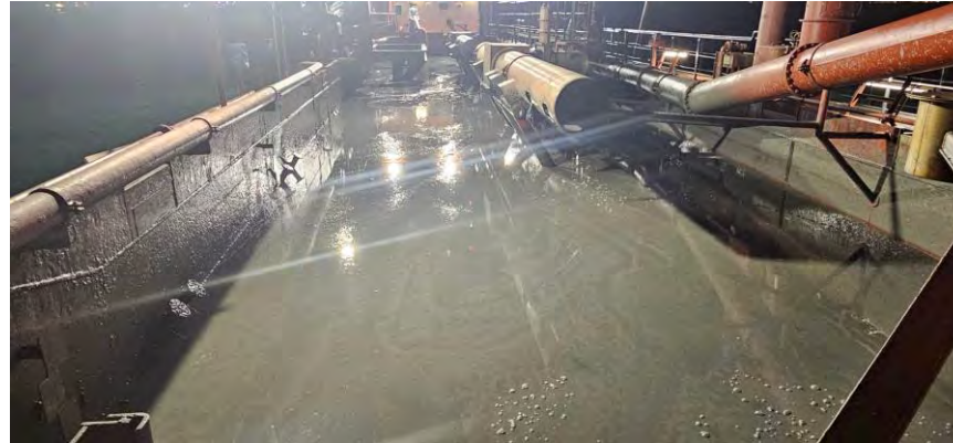
Figura 07 - Seguimiento y control arqueológico del dragado para la Fase II de la ampliación de la NTC, a bordo de la Viking R. Supervisión de la cántara tras la 2ª carga completada en el turno. La cantidad de agua mantenida a bordo no permite la revisión del material extraído. Resultado negativo.
