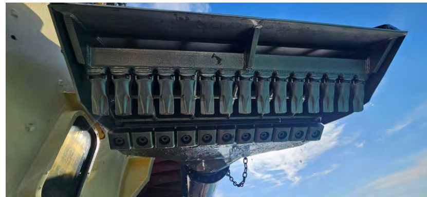
Figura 06 - Seguimiento y control arqueológico del dragado para la Fase II de la ampliación de la NTC, a bordo de la Viking R. Revisión de la cabeza de succión tras la 2ª carga completada en el turno. Resultado negativo.
