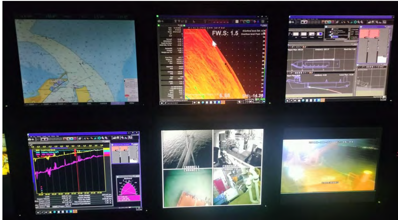
Figura 05 – Seguimiento y control arqueológico de la Fase II de la ampliación de la NTC a bordo del Brage R. Monitores con la zona de dragado, batimetría y posición de la draga en la zona de la bocana del puerto de Cádiz durante una de las cargas del turno de noche.
