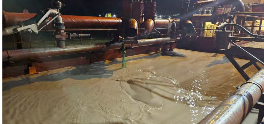
Figura 11 - Seguimiento y control arqueológico del dragado para la Fase II de la ampliación de la NTC, a bordo de la Brage R. Supervisión de la cántara tras la 3ª carga completada. La cantidad de agua mantenida a bordo no permite la revisión del material extraído. Resultado negativo.
