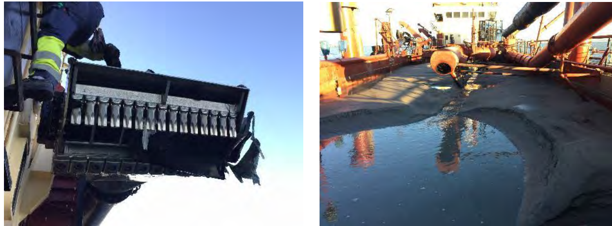
Figura 01 - Seguimiento y control arqueológico del dragado para la Fase II de la ampliación de la NTC, a bordo de la Viking R. Imágenes de la revisión del cabezal de succión y del sedimento extraído en la 1ª carga. Resultado positivo.
