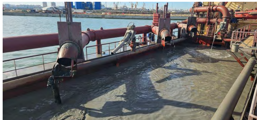
Figura 02 - Seguimiento y control arqueológico del dragado para la Fase II de la ampliación de la NTC, a bordo de la Brage R. Supervisión de la cántara tras la 1ª carga completada. La cantidad de agua mantenida a bordo no permite la revisión del material extraído. Resultado negativo.
