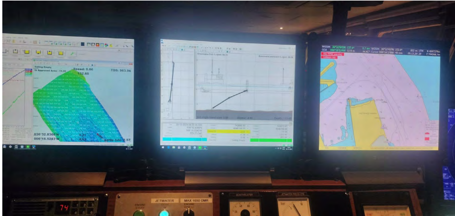
Figura 05 – Seguimiento y control arqueológico de la Fase II de la ampliación de la NTC a bordo del Viking R. Monitores con la zona de dragado, batimetría y posición de la draga en la zona de la bocana del puerto de Cádiz durante la 3ª carga del turno de noche.
