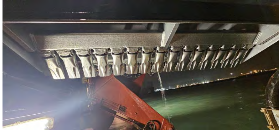
Figura 05 - Seguimiento y control arqueológico del dragado para la Fase II de la ampliación de la NTC, a bordo de la Viking R. Revisión de la limpieza de la cabeza de succión tras la 2ª carga completada en el turno. Material de desecho. Resultado negativo.
