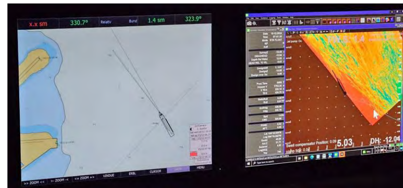
Figura 10 - Seguimiento y control arqueológico de la Fase II de la ampliación de la NTC, a bordo de la Brage R. Supervisión de las labores de dragado, trazado, tipo de sedimento,.. Monitor del multihaz con la zona de dragado, las profundidades y la posición de la draga en la bocana del puerto durante la 4ª carga iniciada en el turno.
