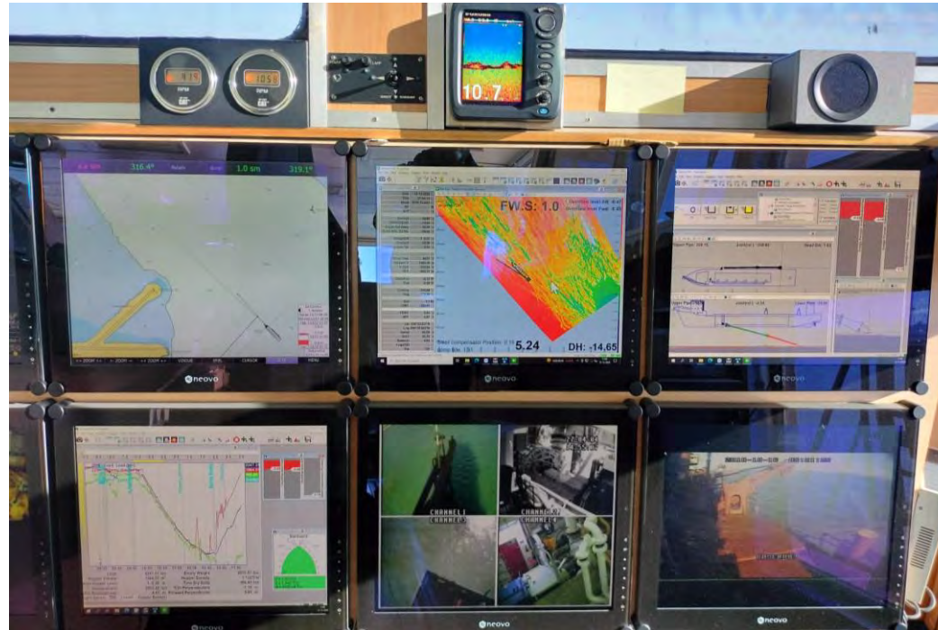
Figura 05 – Seguimiento y control arqueológico de la Fase II de la ampliación de la NTC a bordo del Brage R. Monitores con la zona de dragado, batimetría y posición de la draga en la zona de la bocana del puerto de Cádiz durante una de las cargas del turno de día.
