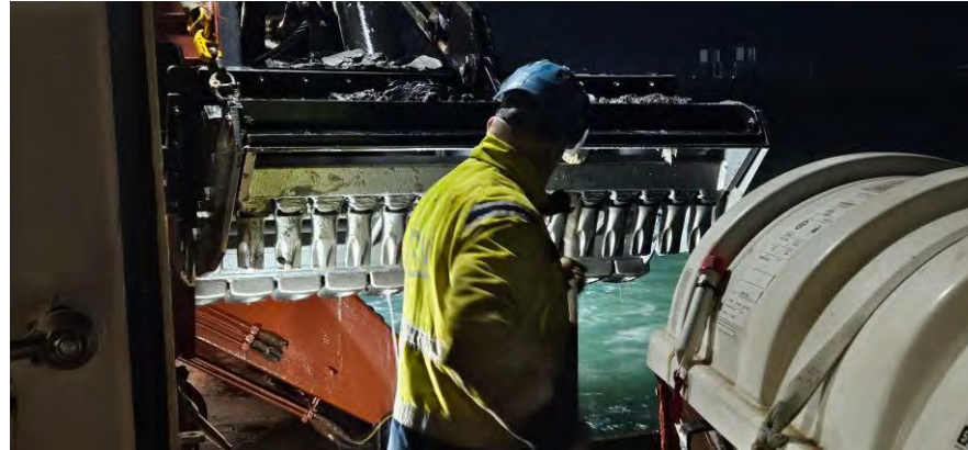
Figura 07 - Seguimiento y control arqueológico del dragado para la Fase II de la ampliación de la NTC, a bordo de la Viking R. Revisión de la cabeza de succión tras la 2ª carga completada en el turno. Resultado negativo.
