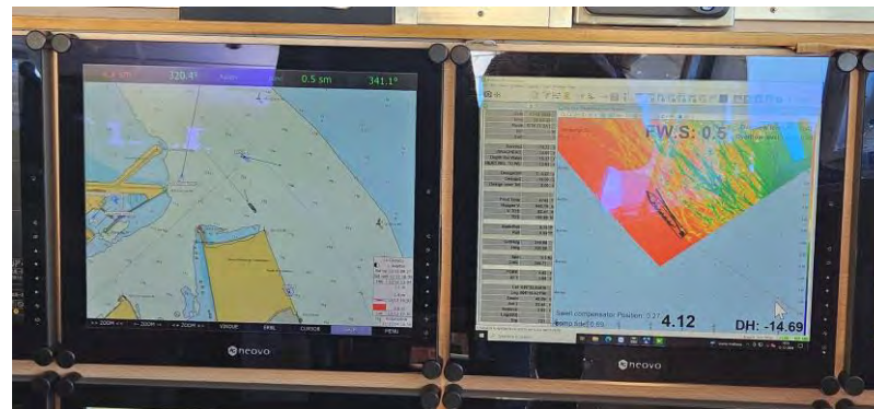
Figura 10 - Seguimiento y control arqueológico de la Fase II de la ampliación de la NTC, a bordo de la Brage R Supervisión de las labores de dragado, trazado, tipo de sedimento,.. Monitor del multihaz con la zona de dragado, las profundidades y la posición de la draga en la bocana del puerto durante la 3ª carga realizada en el turno.
