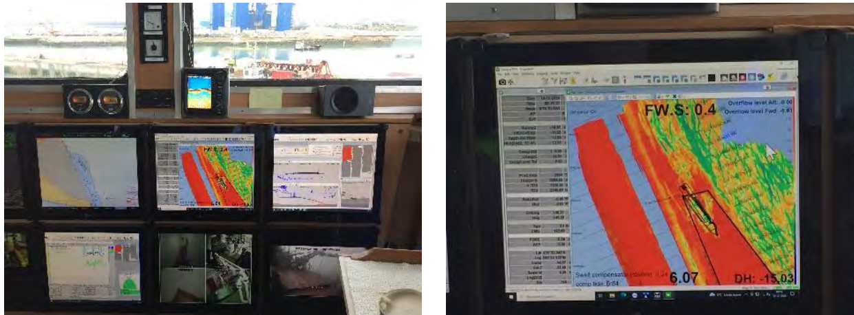
Figura 01 - Seguimiento y control arqueológico del dragado para la Fase II de la ampliación de la NTC, a bordo de la Brage R. Imágenes de monitorización de los trabajos de dragado y detalle de la batimetría multihaz durante la primera carga. Resultado positivo.
