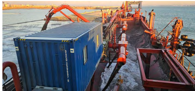
Figura 01 - Seguimiento y control arqueológico de la Fase II de la ampliación de la NTC, a bordo de la Viking R. Supervisión de la 1ª descarga realizada en el turno a través de lanza para el relleno del cajón 06.
