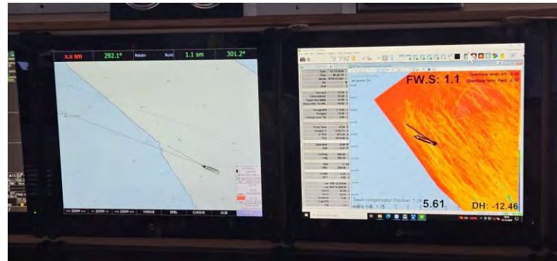
Figura 01 - Seguimiento y control arqueológico de la Fase II de la ampliación de la NTC, a bordo de la Brage R Supervisión de las labores de dragado, trazado, tipo de sedimento,.. Monitor del multihaz con la zona de dragado, las profundidades y la posición de la draga en la bocana del puerto durante la 1ª carga realizada en el turno.
