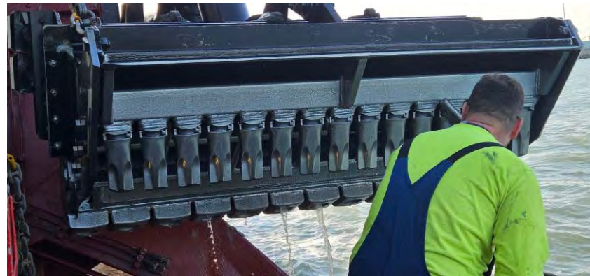
Figura 02 - Seguimiento y control arqueológico del dragado para la Fase II de la ampliación de la NTC, a bordo de la Viking R. Revisión de la limpieza de la cabeza de succión tras la primera carga completada en el turno. Material de desecho. Resultado negativo.
