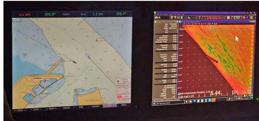
Figura 09 - Seguimiento y control arqueológico de la Fase II de la ampliación de la NTC, a bordo de la Brage R Supervisión de las labores de dragado, trazado, tipo de sedimento,.. Monitor del multihaz con la zona de dragado, las profundidades y la posición de la draga en la bocana del puerto durante la 3ª carga iniciada en el turno.
