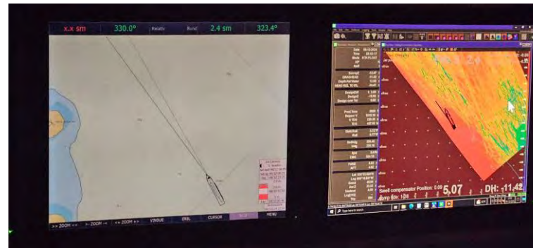
Figura 02 - Seguimiento y control arqueológico de la Fase II de la ampliación de la NTC, a bordo de la Brage R Supervisión de las labores de dragado, trazado, tipo de sedimento,.. Monitor del multihaz con la zona de dragado, las profundidades y la posición de la draga en la boca del puerto durante la 1ª carga realizada en el turno.
