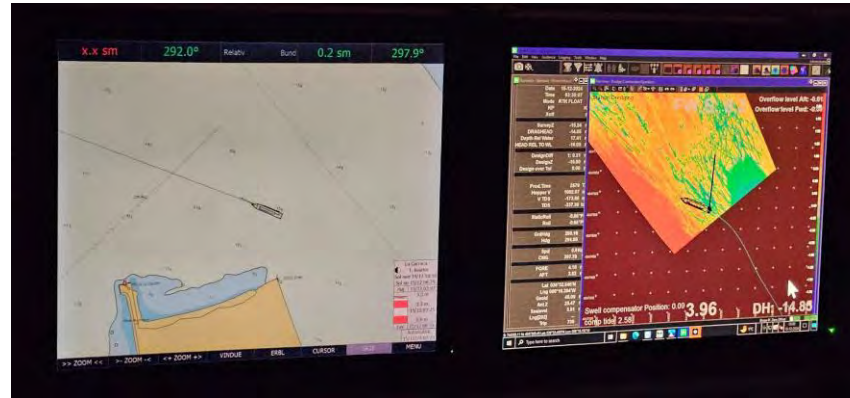
Figura 07 - Seguimiento y control arqueológico de la Fase II de la ampliación de la NTC, a bordo de la Brage R. Supervisión de las labores de dragado, trazado, tipo de sedimento,.. Monitor del multihaz con la zona de dragado, las profundidades y la posición de la draga en la boca del puerto durante la 3ª carga iniciada en el turno.
