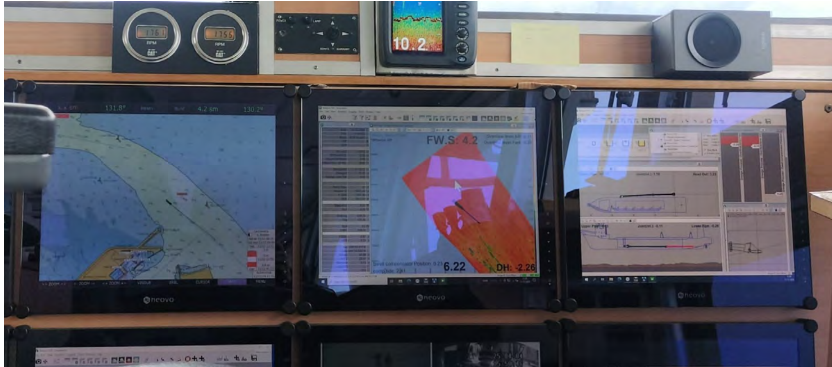
Figura 05 – Seguimiento y control arqueológico de la Fase II de la ampliación de la NTC a bordo del Brage R. Monitores con la zona de dragado, batimetría y posición de la draga en la zona de la bocana del puerto de Cádiz durante una de las cargas del turno de día.
