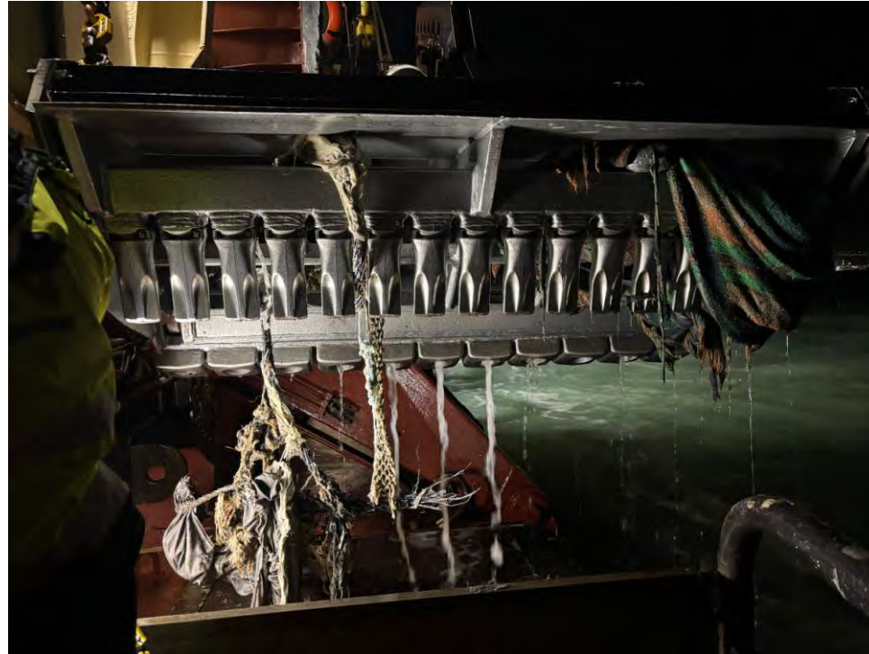
Figura 02- Seguimiento y control arqueológico del dragado para la Fase II de la ampliación de la NTC, a bordo de la Viking R. Revisión de la limpieza de la cabeza de succión tras la 2ª carga completada en el turno. Resultado negativo.
