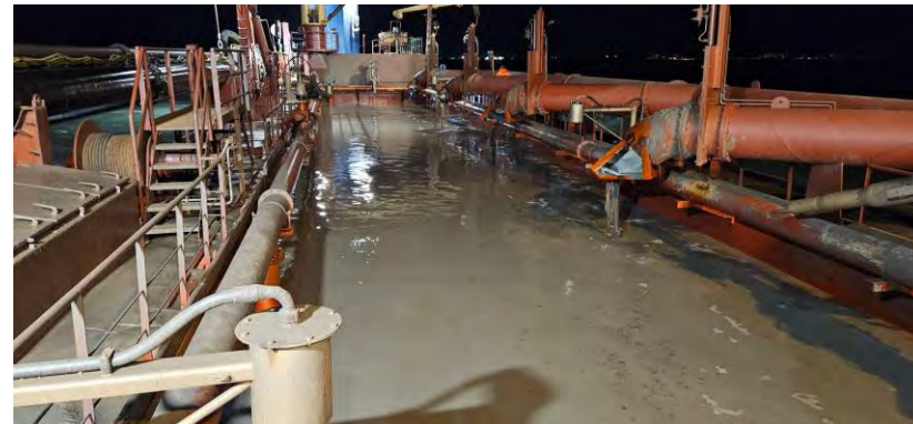
Figura 06 - Seguimiento y control arqueológico del dragado para la Fase II de la ampliación de la NTC, a bordo de la Brage R. Supervisión de la cántara tras la 2ª carga completada. La cantidad de agua mantenida a bordo no permite la revisión del material extraído. Resultado negativo.
