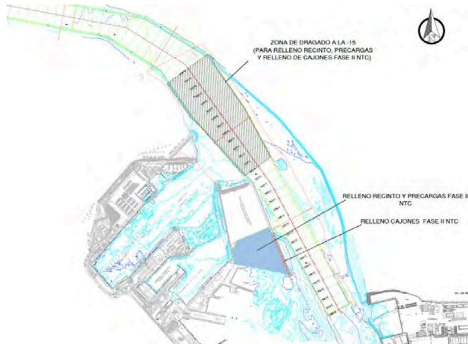
Dragado de profundización de la **canal de acceso al Puerto de la Bahía de Cádiz. Zona frente a la bocana del puerto.** Profundidad media al inicio entre -11 y -14 metros. Se proyecta la extracción de un volumen total de dragado de 1.144.500 m<sup>3</sup>, a lo largo de un área de más de 1,5 km aproximadamente hasta una cota (profundidad) de -15 metros, para el relleno de cajones y la dársena de la Fase II. El sedimento está compuesto principalmente por arenas y, en menor medida, fangos.
