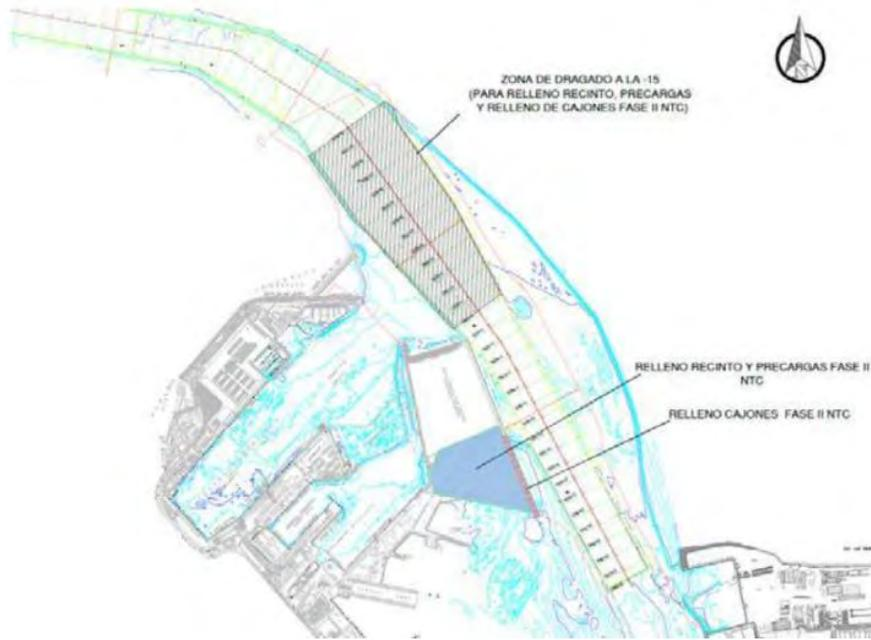
Dragado de profundización de la canal de acceso al Puerto de la Bahía de Cádiz. Zona frente a la bocana del puerto. Profundidad media al inicio entre -11 y -14 metros. Se proyecta la extracción de un volumen total de dragado de 1.144.500 m<sup>3</sup>, a lo largo de un área de más de 1,5 km aproximadamente hasta una cota (profundidad) de -15 metros, para el relleno de cajones y la dársena de la Fase II de la NTC. El sedimento está compuesto principalmente por arenas y, en menor medida, fangos.
