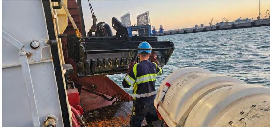
Figura 05 - Seguimiento y control arqueológico del dragado para la Fase II de la ampliación de la NTC, a bordo de la Viking R. Revisión de la limpieza de la cabeza de succión tras la 4ª carga completada en el turno. Material de desecho. Resultado negativo.
