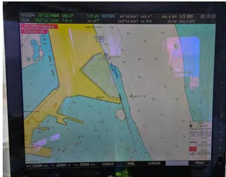
Figura 01 - Seguimiento y control arqueológico de la Fase II de la ampliación de la NTC. Supervisión de las labores de dragado, trazado, tipo de sedimento,...1ª carga del turno de día. Monitor con la zona de dragado, las profundidades y la posición de la draga.
