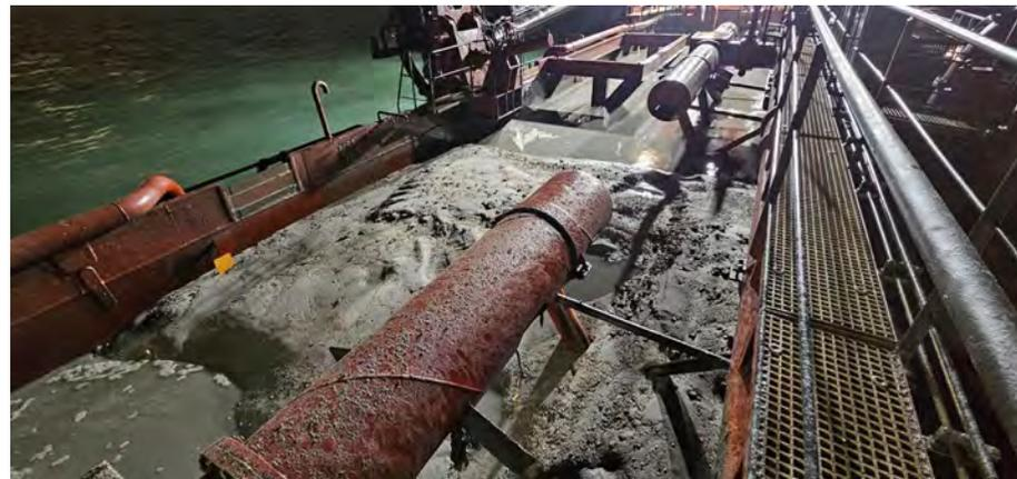
Figura 04 - Seguimiento y control arqueológico del dragado para la Fase II de la ampliación de la NTC, a bordo de la Viking R. Supervisión de la cántara tras la 2ª carga del turno, detalle del tipo de sedimento (fangos, margas y limos arenosos y piedras). Resultado negativo.
