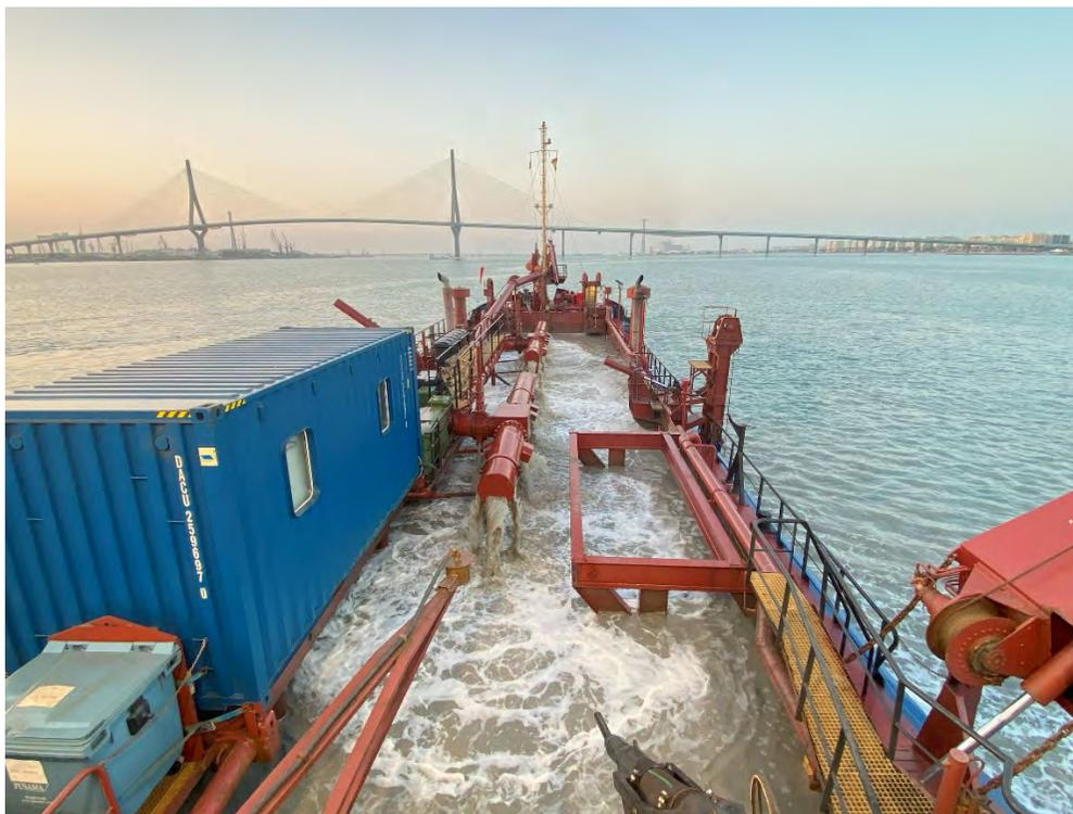
Figura 01 - Seguimiento y control arqueológico del dragado para la Fase II de la ampliación de la NTC, a bordo de la Viking R. Inspección de la canta durante el dragado. Análisis de sedimento, grado de compactación, aparición de materiales en suspensión, etc.
