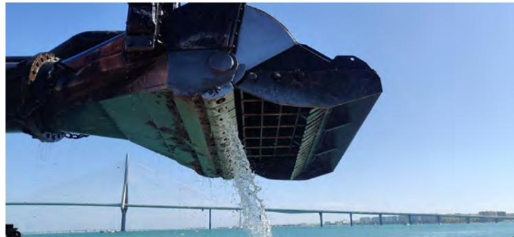
Figura 01 - Seguimiento y control arqueológico del dragado a bordo del Brage R para la fase II de la ampliación de la NTC. Detalle del cabezal limpio de sedimentos y materiales arqueológicos.
